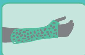
Escaneando la extremidad, se obtiene la medida para modelar en 3D una férula adaptada a cada paciente. Se fabrica normalmente con impresión 3D de SLS y FDM en plástico o resina.
